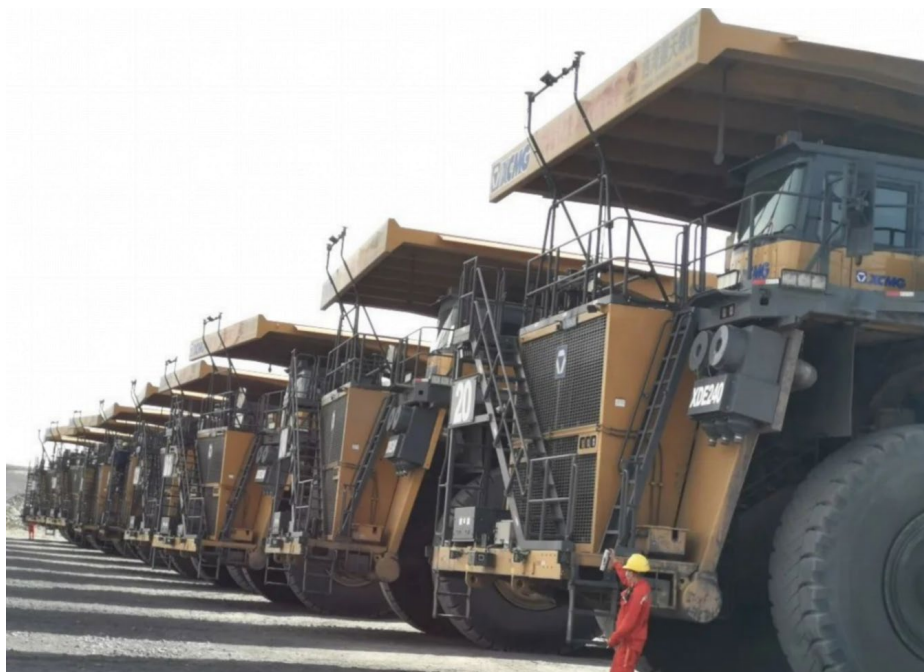
西湾露天矿卡项目实现矿用卡车“装-运-卸”全流程无人驾驶和辅助车辆的协同作业
