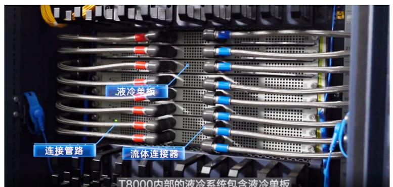
图 5-9 液冷核心路由器
