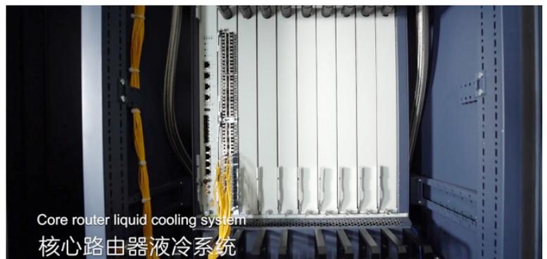
图 5-9 液冷核心路由器
