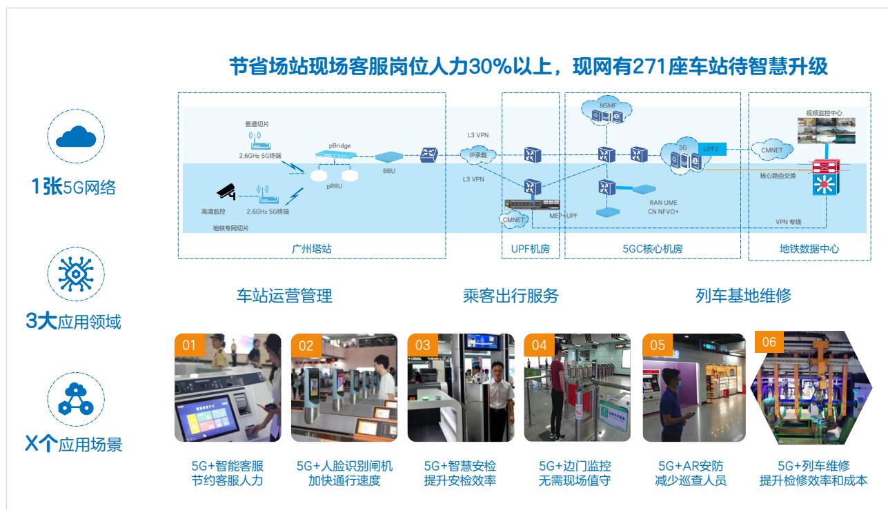
图 4-5 5G+ 智慧地铁 1+3+X 架构
