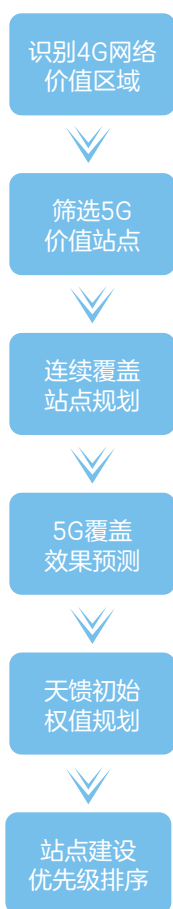
图 3-1 5G 网络精准规划流程
