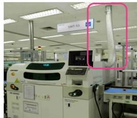
回流炉配置独立冰水机及抽风罩
