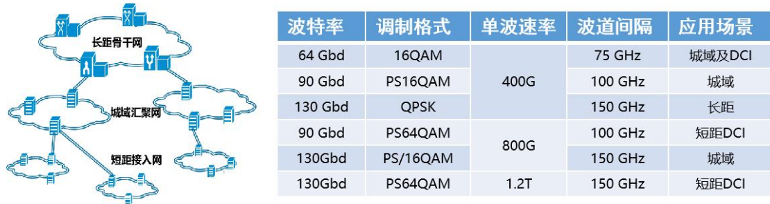
图 3.1 800 及以上高速光传输调制格式及其应用场景
