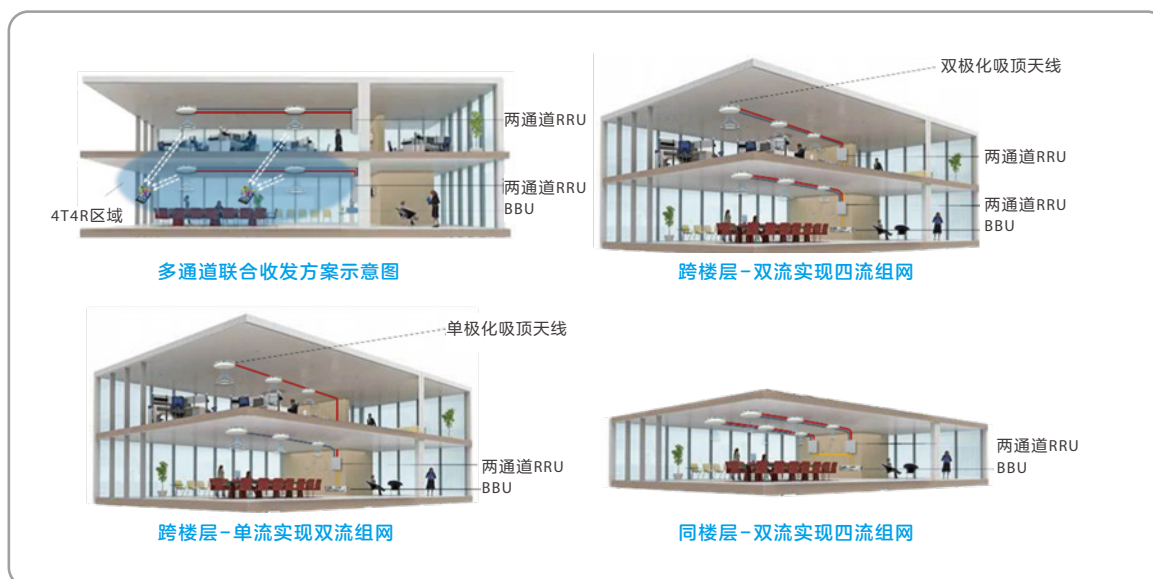
图1 eDAS原理及三种改造方案
