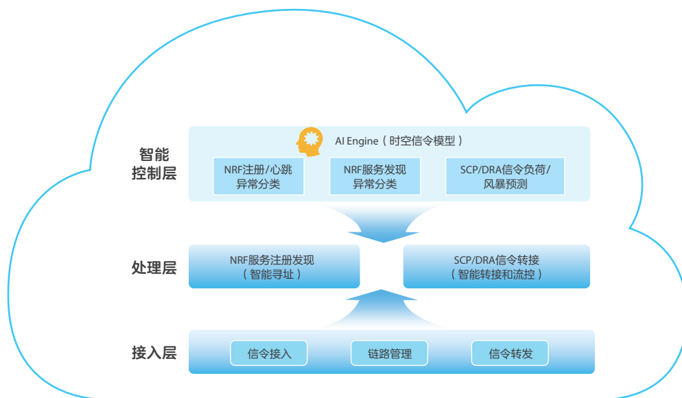
▲图1 “AI+” 信令网架构
