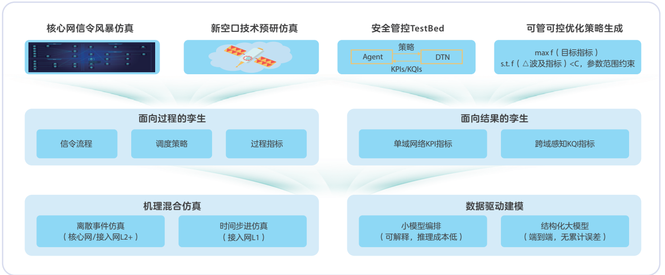
▲ 图2 通信网络全域数字孪生引擎架构
