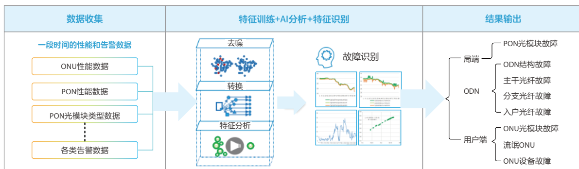
▲ 图1 基于AI的PON接入网质量分析实现原理
