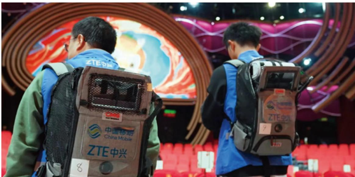
话务密集区域部署了700MHz+2.6GHz+4.9GHz三频段三载波(3CC)聚合5G-A网络,通过高低频紧密配合实现网络能力最大化,现场实测单用户体验较2.6GHz单频提升两倍以上,为游客观看直播、上传打卡视频、体验XR、裸眼3D等新应用提供了强大支撑。
