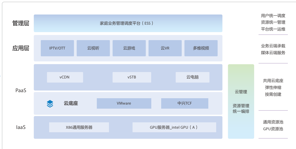
图1 基于算力网络部署vSTB架构图
