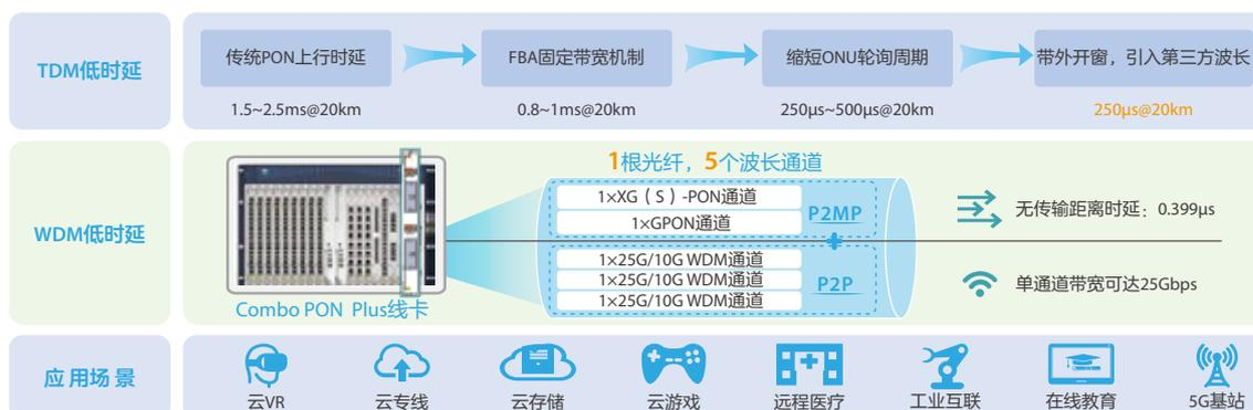
图1 通过PON技术优化和引入WDM机制改进PON网络时延
