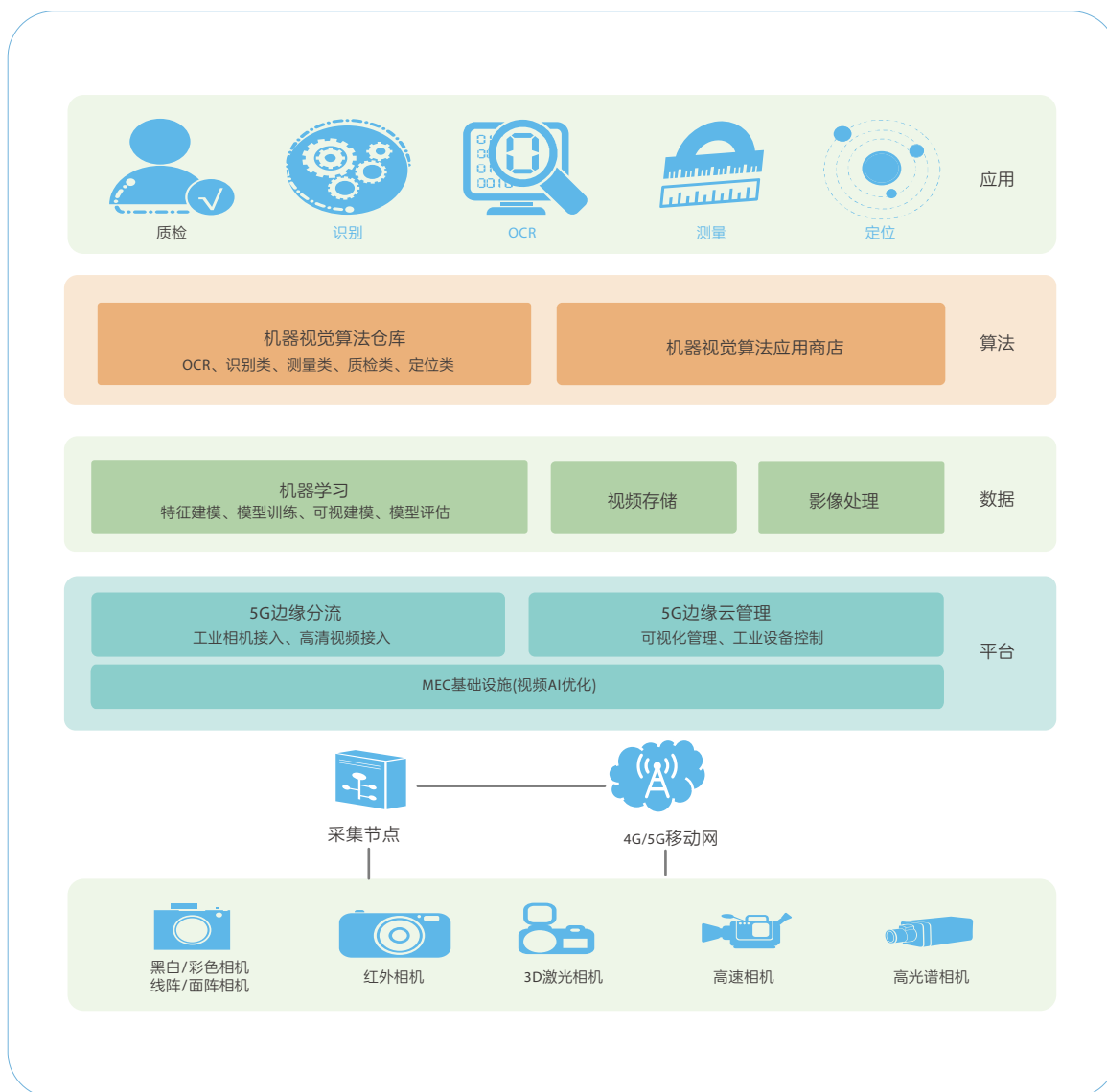
图1 基于MEC的通用机器视觉平台架构
