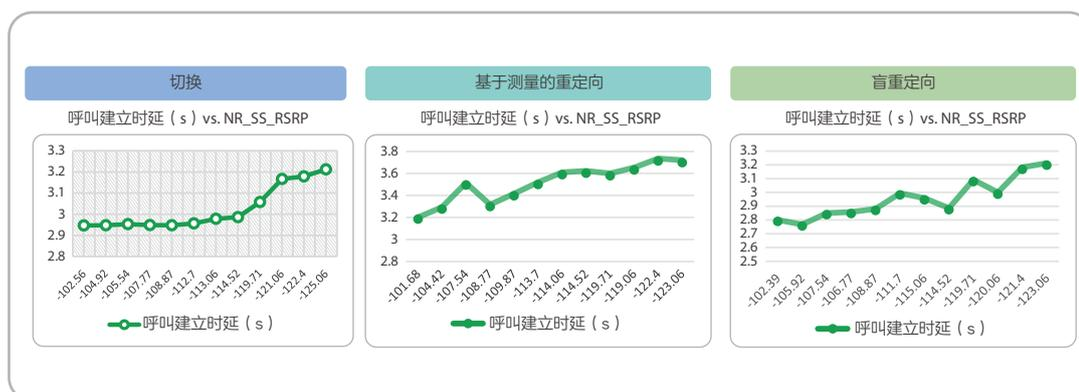
图2 外场测试结果：EPS Fallback三种方式的呼叫建立时延
