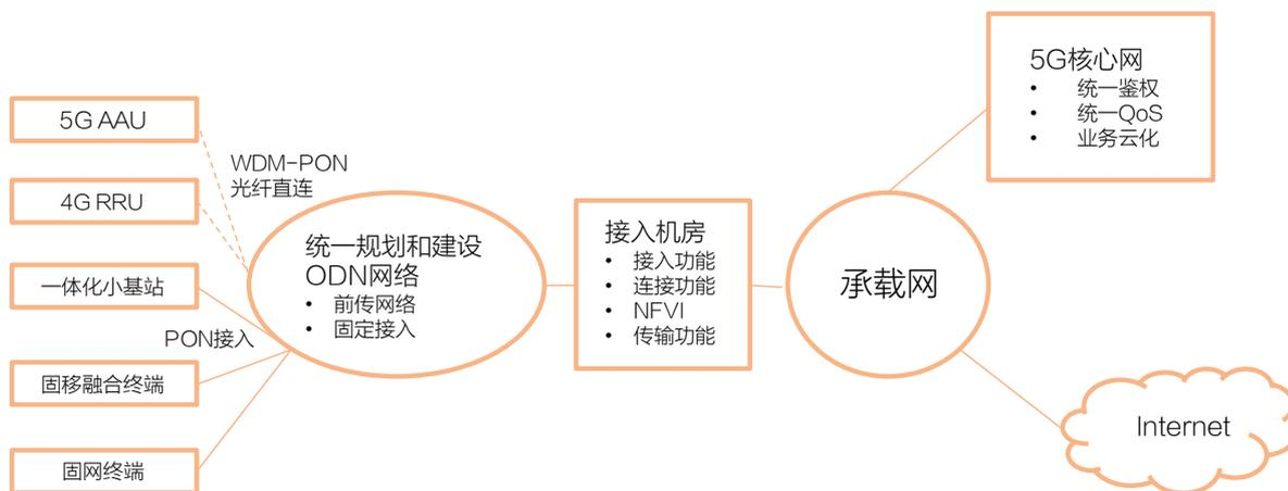
图1 5G时代接入机房在网络中成为有线无线接入的门户
