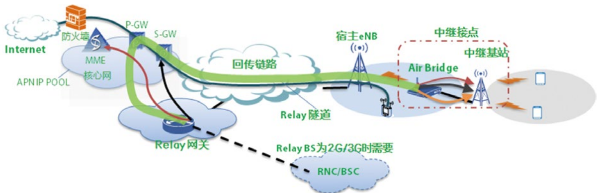
图3 Smart Relay工作原理图
