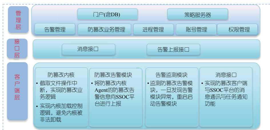
图1 EPG防篡改系统的功能架构
