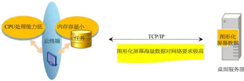
图2 VDI云桌面系统典型架构
