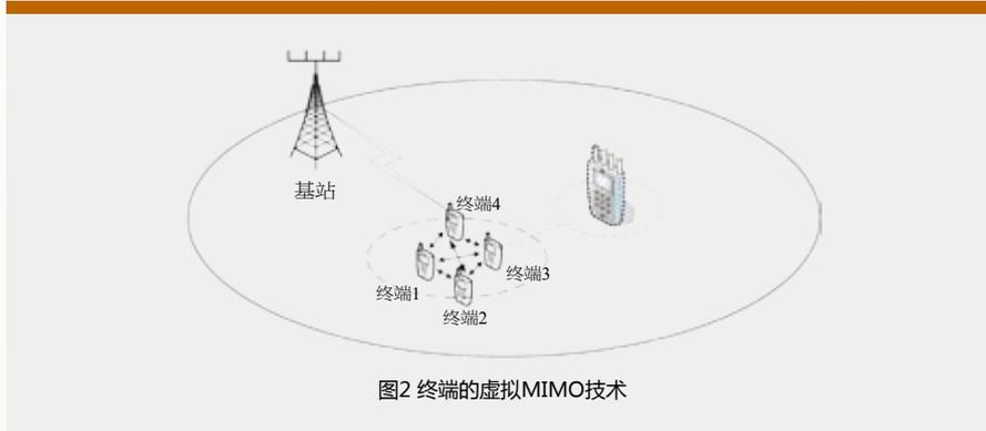
收分集接收机（见图2），可以明显提高从宏基站到终端的链路容量和可靠性。对于虚拟的SU-MIMO接收机，由于SU-MIMO对于传统MU-MIMO可以获得最佳的链路性能，这对改善用户比较密集的热点地区的通信状况有非常大的好处；对于虚拟的接收分集接收机，同一小区边缘位置的多个用户的接收天线可以共享，可以改善小区边缘覆盖。该技术可以提升系统的频谱效率和边缘可靠性。
