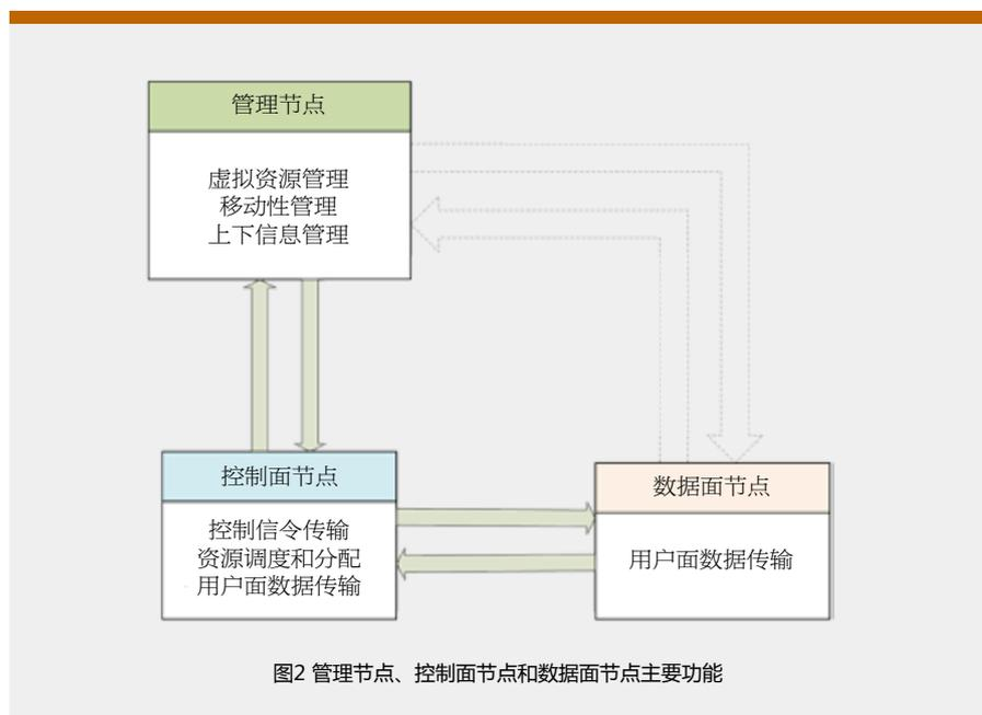
图2 管理节点、控制面节点和数据面节点主要功能
