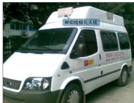
图2 安装了车载阅读器和天线的车辆
