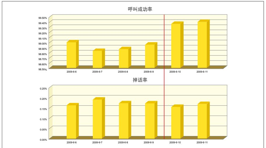
图3 N市应用CDT进行精细优化后性能KPI变化图
