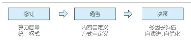
▲图3 算力感知网络中算力通告的流程
