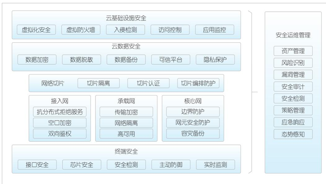
▲图6 基于5G超级用户身份识别模块(SIM)的端云体系架构
