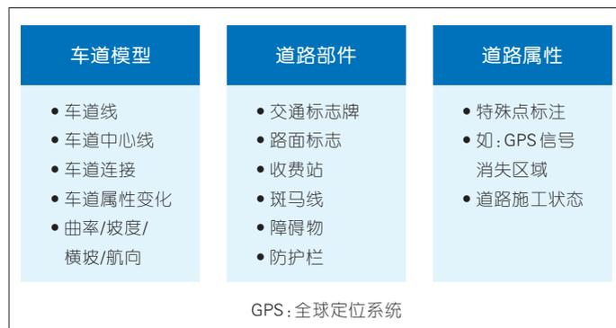
线、车道中心线、车道属性变化等信息,可以辅助车辆完成横向定位,并且执行交通规则,比如指导车辆在虚线区域内进行并线,在车道分离点前完成变道。通过对比车载传感数据与交通标志牌等道路部件信息,可以修正车辆纵向定位和航向。即便在没有检测到任何道路特征的情况下,也可以通过高精地图的航位推算进行短时间的推位置推算。车道模型中曲率、坡度、航向、横坡等数学参数,可以决策车辆准确的转向、制动、爬坡等行为。这部分数据因为道路翻新和维护出现频繁变化,需要有效地利用边缘群智感知进行更新。
