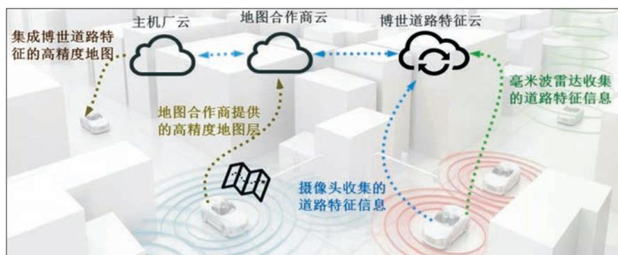
▲图5 博世高精地图系统示意图
