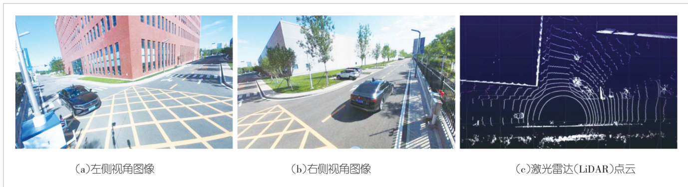
图2 北京亦庄自动驾驶区多模态环境感知:多视角图像与LiDAR点云
