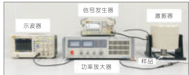
图7 摩擦纳米发电机测试平台
