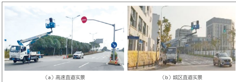
▲图 4 车与物通信高速直道测试场景
