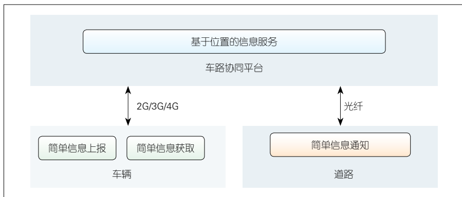
▲图 1 车路协同 1.0 架构图
