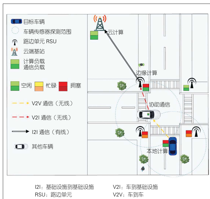
▲图 2 车联网边缘节点协同计算模型
