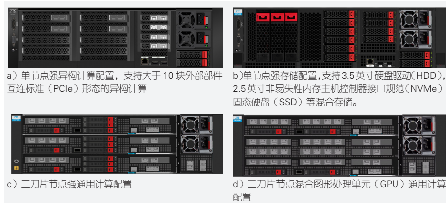
▲ 图 5 中兴通讯开放边缘平台系列边缘定制化服务器
