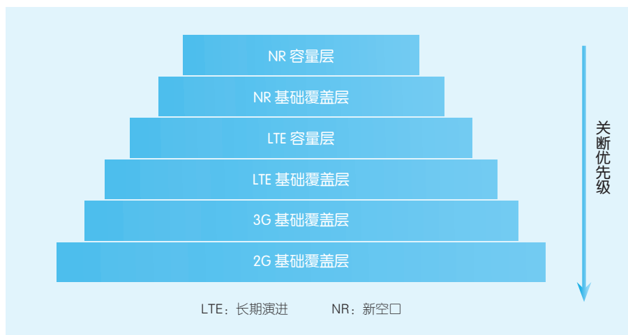
▲ 图 2 载波 (服务小区) 的关闭优先级
