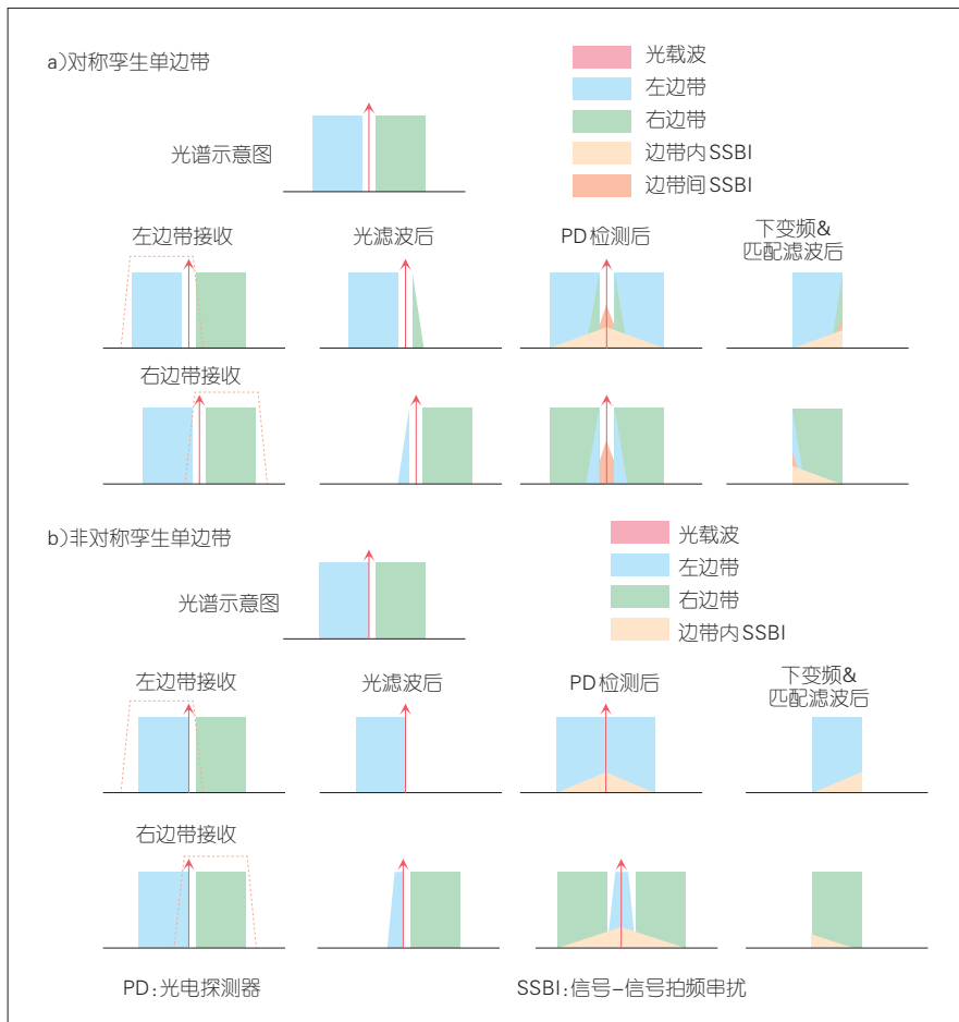
▲图6 对称和非对称单生单边带接收原理示意图
