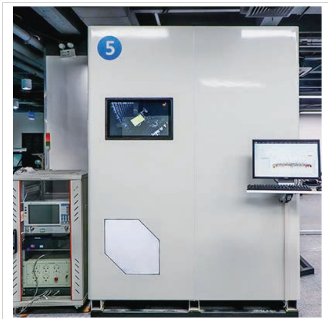
▲图10 自动化微型相控阵天线测试系统
