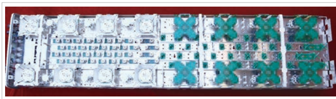
▲图 8 跨频段共口径大规模天线阵列
