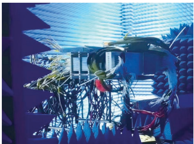
▲图4 64T16R非对称全数字多波束阵列天线原理样机与动态性能测试
