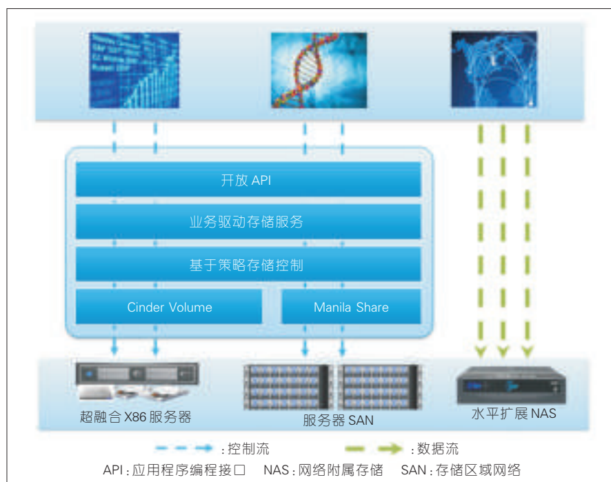
▲ 图2 软件定义存储的控制平面
