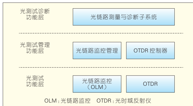
图4 光链路测量与诊断系统的功能构成
