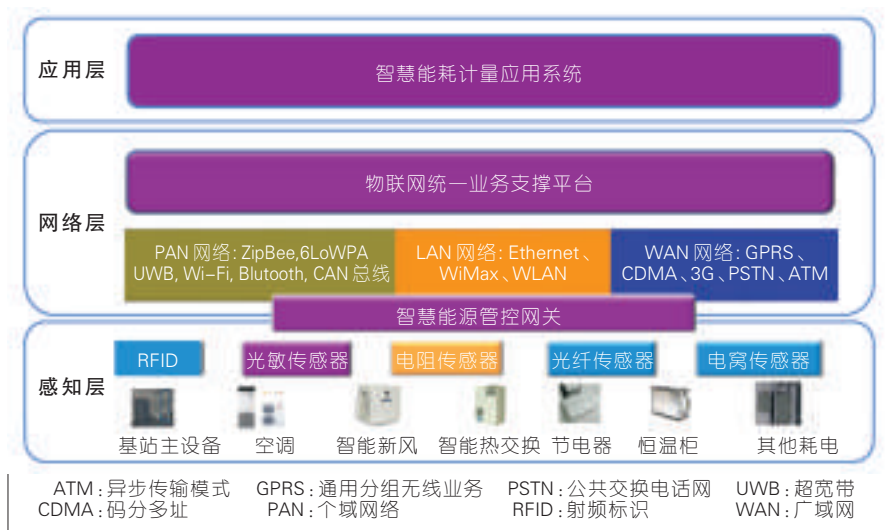
▲图1 智慧能耗计量平台体系架构
