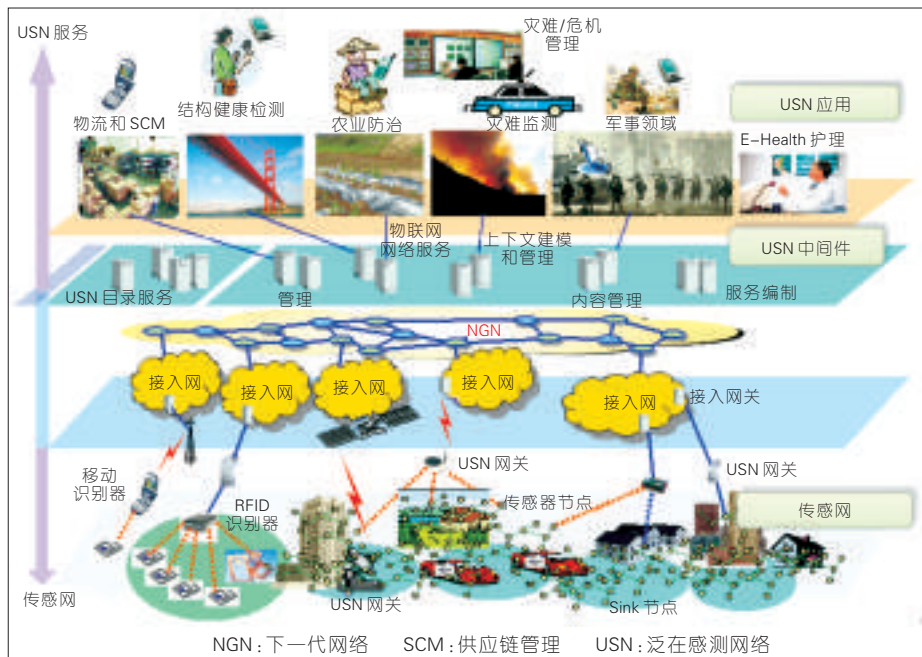
▲图4 ITU-T提出的物联网架构
