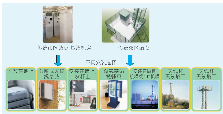
▲图2 光载射频系统站址安装示例图
