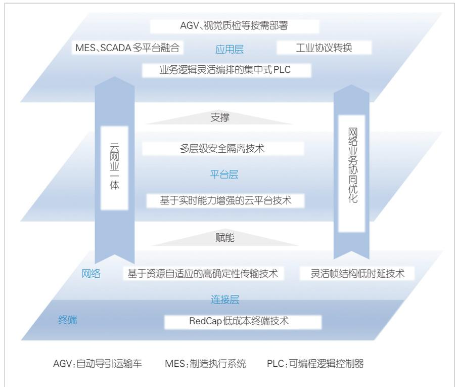
▲图3 集中式PLC新型工业组网架构下的关键使能技术体系
