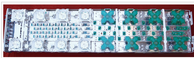
▲图 8 跨频段共口径大规模天线阵列
