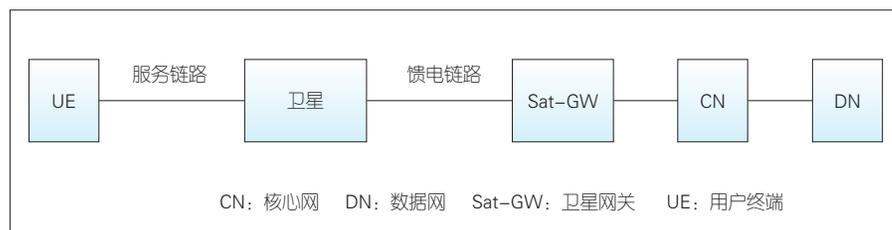
▲图 2 传统卫星通信系统的基本架构
