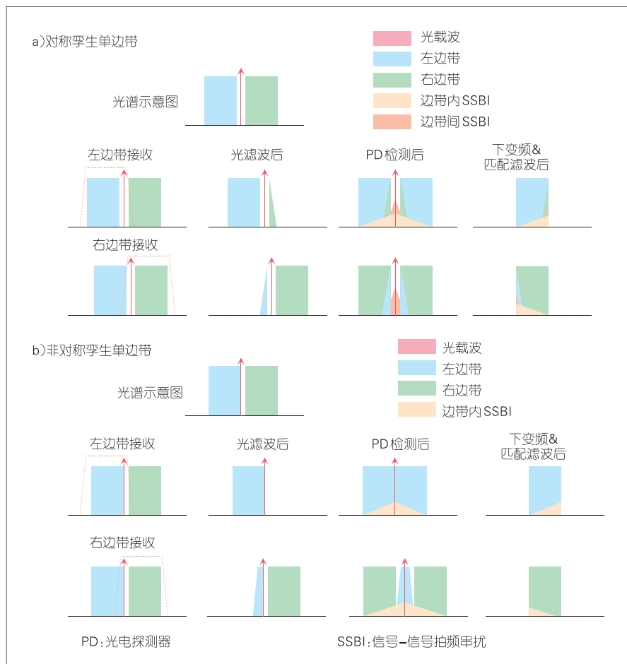
▲图6 对称和非对称孪生单边带接收原理示意图
