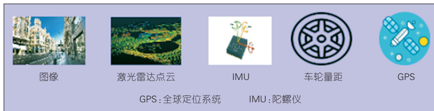
▲图3 高精地图主要传感器类型
