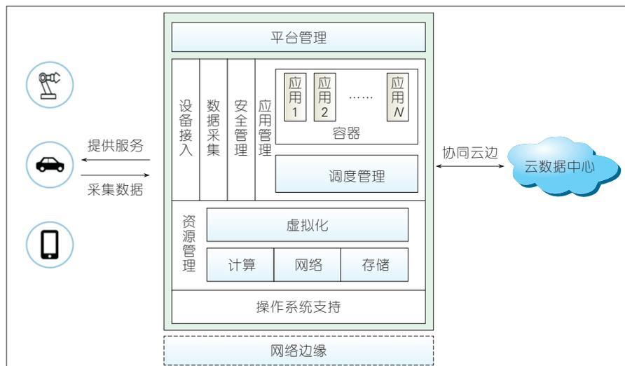
▲图1 边缘计算平台一般性功能框架
