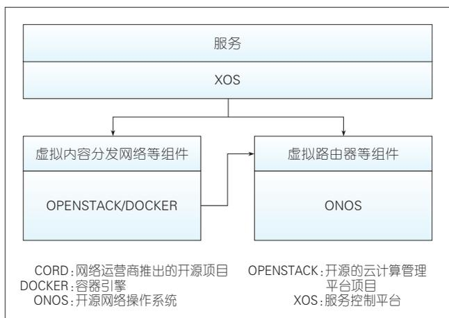
◀图5 CORD的软件架构
