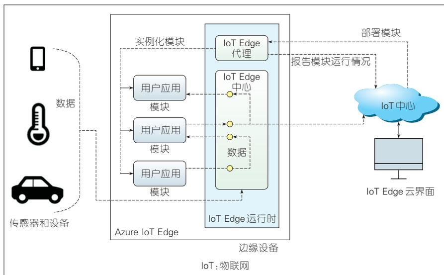
▲图 6 Azure IoT Edge 的架构图
