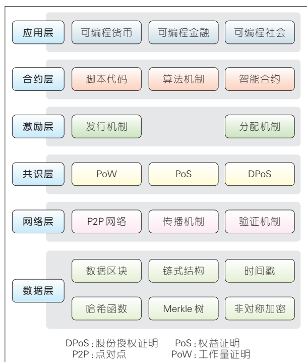
图1 区块链技术的基础架构
