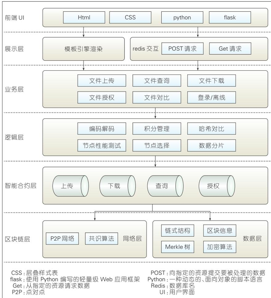
▲ 图1 系统功能架构图
