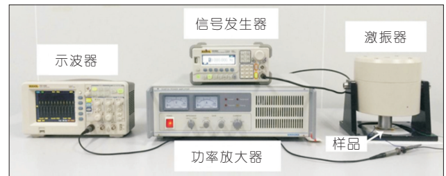
图7 摩擦纳米发电机测试平台
