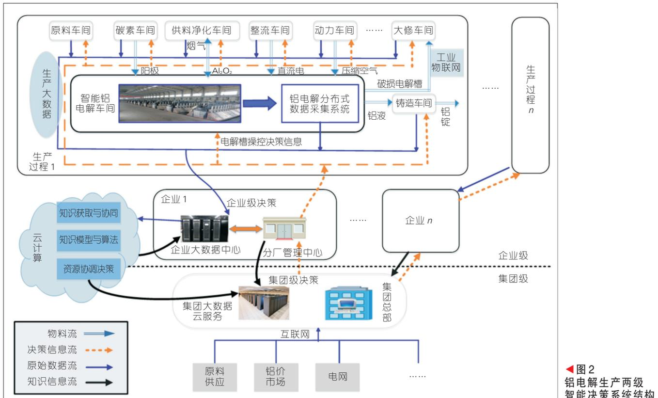
图2 铝电解生产两级智能决策系统结构
