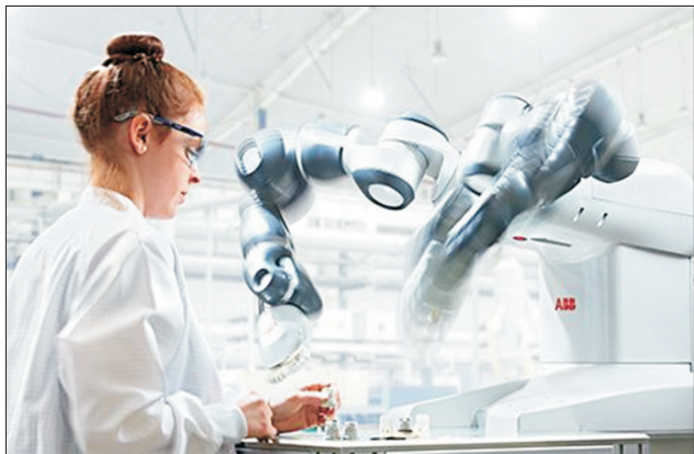
◀图3 ABB YUMI 双臂智能 机器人
