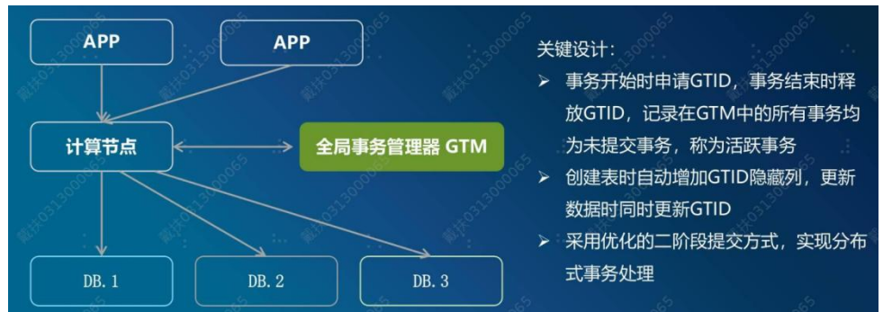
图 4.1-1 GoldenDB 分布式事务控制关键设计
