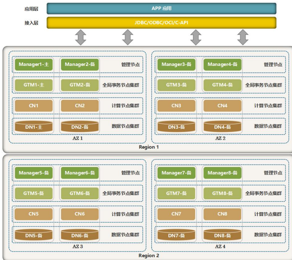
图 3.3-6 两地四中心高可用组网图
