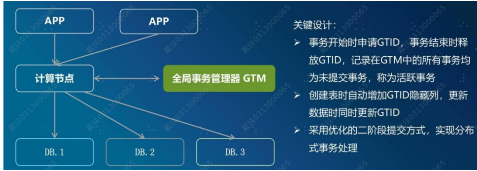
图 4.1-1 GoldenDB 分布式事务控制关键设计
